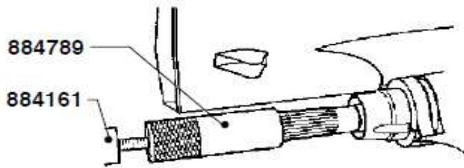
8. Spezialwerkzeug **884789** auf der äußeren Propellerwelle anbringen. Äußere Propellerwelle und Lagergehäuse mithilfe des Spezialwerkzeuges **884161** und eines Schiebehammers ausbauen.
